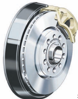
Задний тормозной механизм, устанавливаемый с колёсным диском 16"
