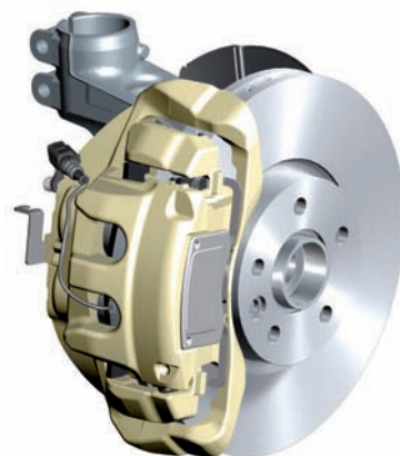
Передний двухпоршневой тормозной механизм, устанавливаемый с колёсным диском 17"
