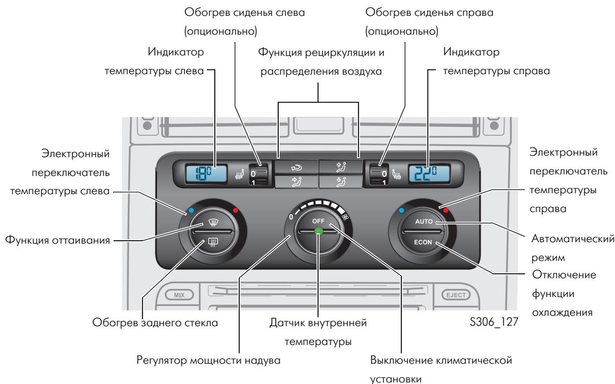
Наряду с регулированием индивидуальной температуры, по желанию водителя и пассажира рядом с ним, климатическая установка может быть включена в автоматический режим. Дополнительно с этим режимом может вручную осуществляться распределение воздуха и устанавливаться мощность надува воздуха. При этом для выбора возможностей по распределению воздуха и рециркуляции на установке 2C-Climatronic имеются органы управления.
