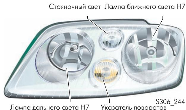
Фара, изготовленная по технологии Vi-Xenon, состоит из газоразрядной лампы для ближнего и дальнего освещения и лампы H7 для усиления дальнего света. Лампа H7 применяется также для функции светового сигнала. Указатели поворотов, а также стояночное освещение расположены также, как и у серийной фары.
