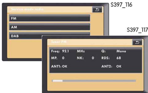
Отображение режима проверки радио на дисплее системы RNS 510
