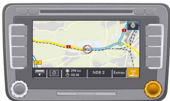
Выбор степени увеличения при ручной настройке масштаба производится с помощью правого поворотного регулятора S397_077
