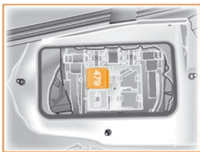
разделительное реле шины данных CAN-Привод J788
