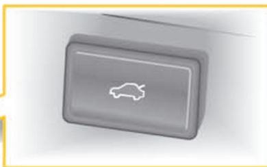
кнопка закрывания задней двери в багажном отсеке E406
