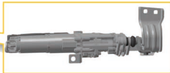
приводной двигатель с управлением, правый (подчиненный)
