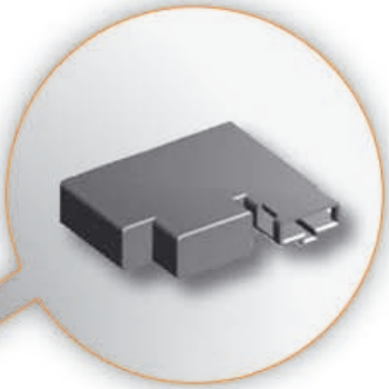
салонная антенна 3 доступа и разрешения запуска двигателя R154 – только в седане
