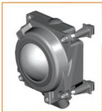
блок управления системы контроля дистанции J428 с датчиком автоматической системы поддержания дистанции G550
