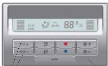
Задний пульт управления системой Climatronic
